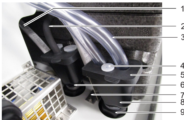
figura 3-26 Imbuto di raccolta per lo scarico separato di tutti i liquidi
