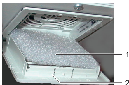
figura 5-16 Sostituzione del tappetino filtro inferiore
