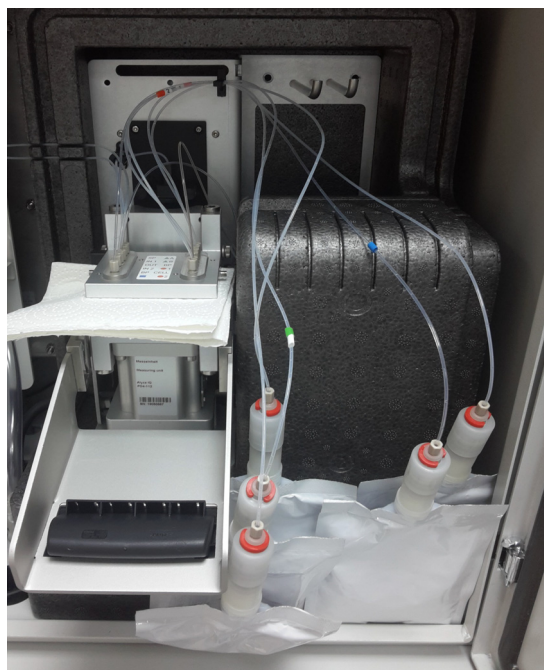
figura 5-20 Carta assorbente nel ricettacolo della valvola MultiPort
