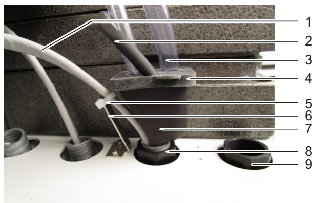
figura 3-25 Imbuto di raccolta per lo scarico comune di tutti i liquidi
