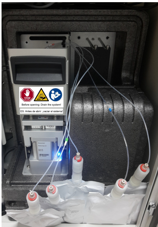
figura 5-19 ChemBag rimosse dall'asta di supporto
